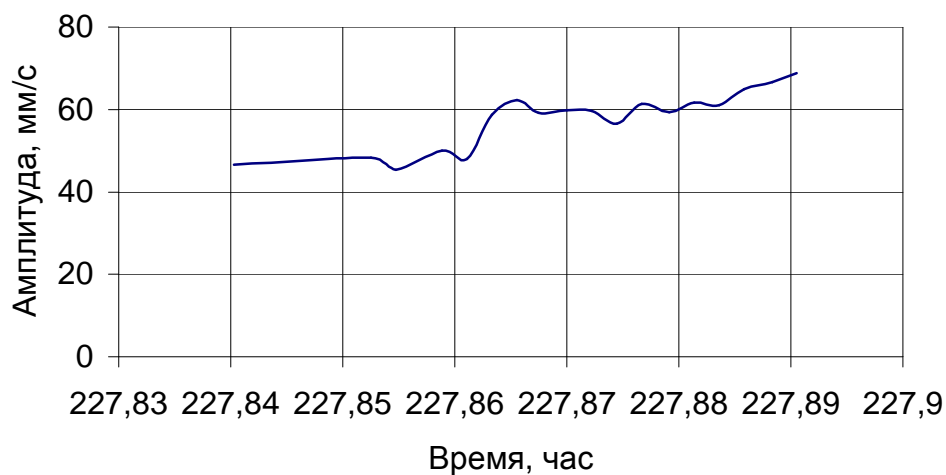
Рис. 4 Тренд общего уровня по датчику \Gamma_T в течение последних 4 минут работы агрегата
