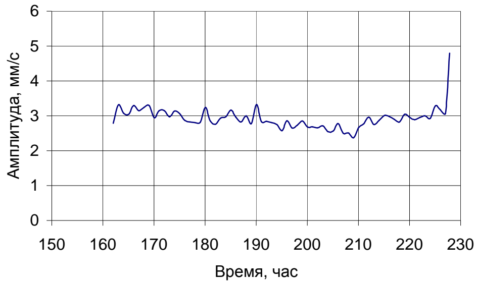
Рис. 5 Тренд составляющей ротора низкого давления по датчику \Gamma_T в течение последних 68 часов работы агрегата
